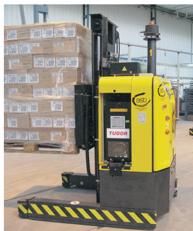
Schnell und staufrei zum Ziel: Fahrerlose Transportfahrzeuge bewegen sich auf vorgegebenen Routen durch Fabriken und Lagerhallen. Foto: Carmenter
