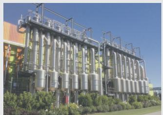
*Bucher Unipektin Fallstromverdampfer, 7-stufig mit Aromarückgewinnung, 115 t/h WVD*
