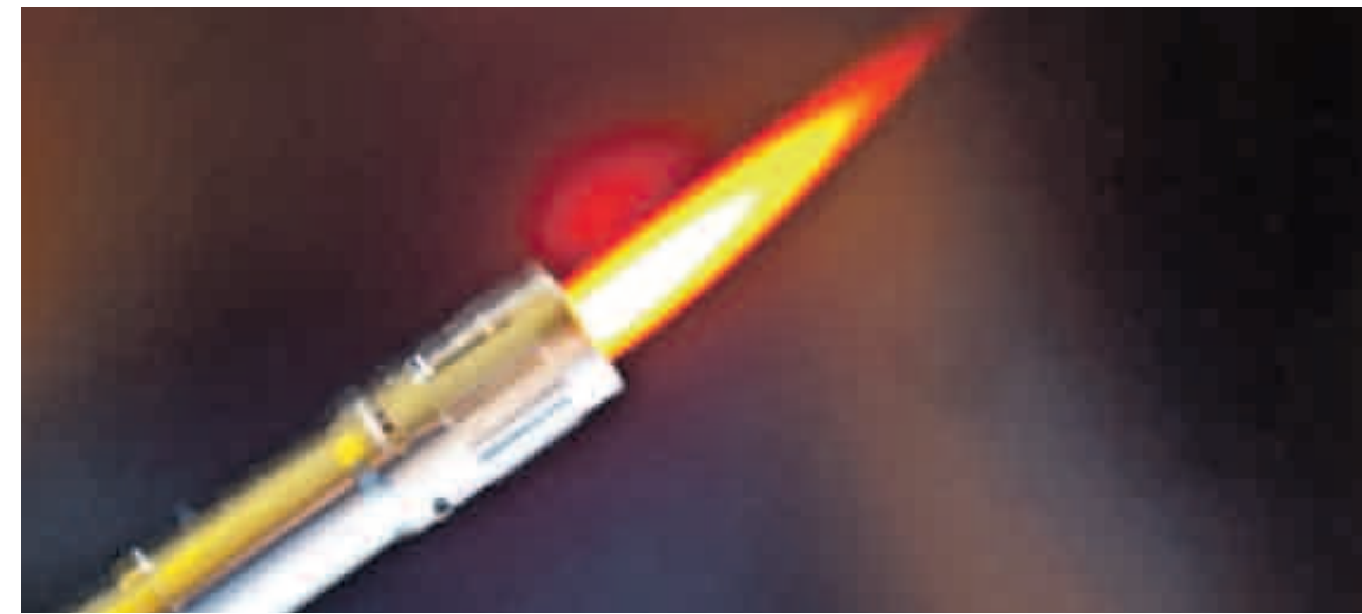
Das so genannte Hochgeschwindigkeits-Suspensions-Flammspritzverfahren erlaubt den Einsatz nanoskaliger Partikel.
