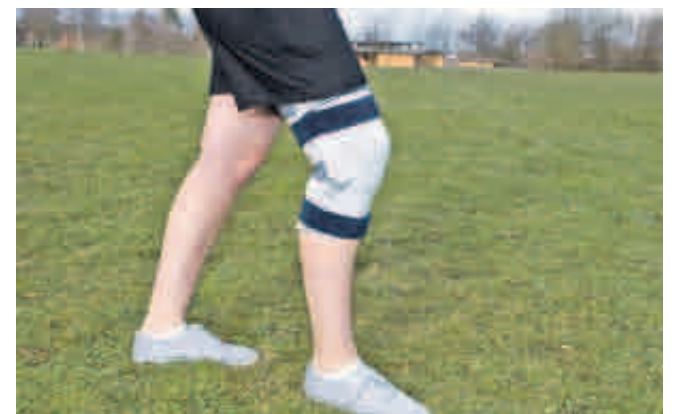
Integrierte Sensoren registrieren den Bewegungswinkel des Knies.
