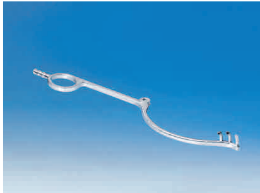
Studie eines chirurgischen Wundspanners mit integrierten Spülkanälen und Anschlussstück. Das OP-Instrument wurde generativ aus Edelstahl gefertigt.
