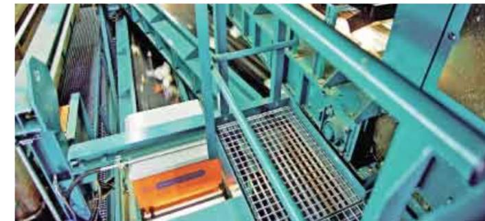
**Sortieranlage für Kunststofftrennung: Nahinfrarottechnik-Aggregate trennen vier Kunststoffarten automatisch.**
