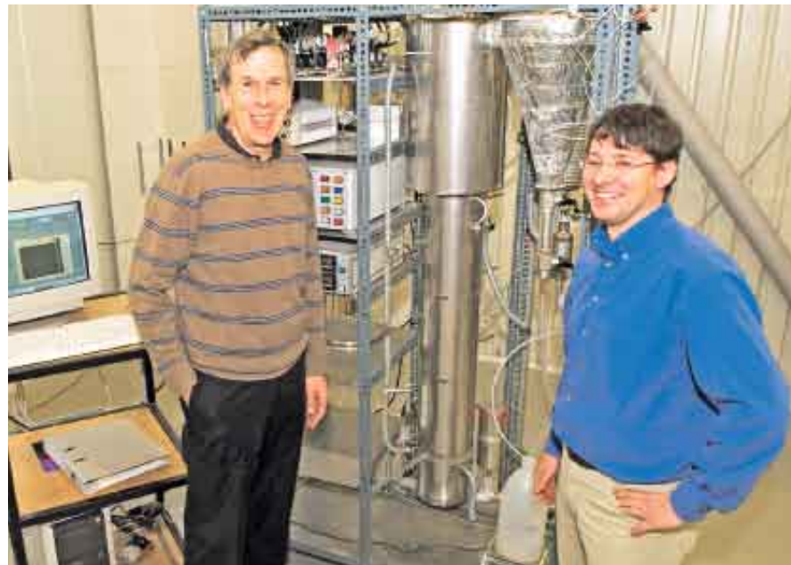
PSI-Forscher Samuel Stucki und Serge Biollaz mit der Laboranlage, an der das Verfahren zur Umwandlung von Holzgas in Methan entwickelt wurde.
