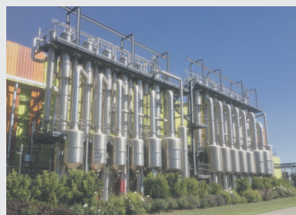
Bucher Unipektin Fallstromverdampfer, 7-stufig mit Aromarückgewinnung, 115 t/h WVD
